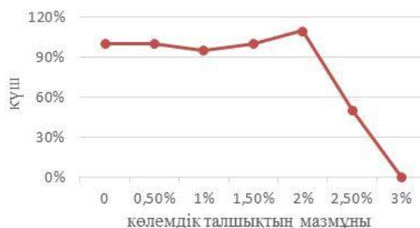
Сурет 1 - Төмен модульді талшықтың көлемдік құрамына байланысты фибробетон беріктігінің өзгеру сипаты (авторлар материалы).
