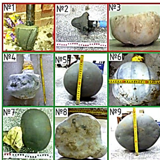
8-сурет – Цилиндрлік науалардағы топырақ массивінде пайда болған кеңейтімдер (автордың материалы).
