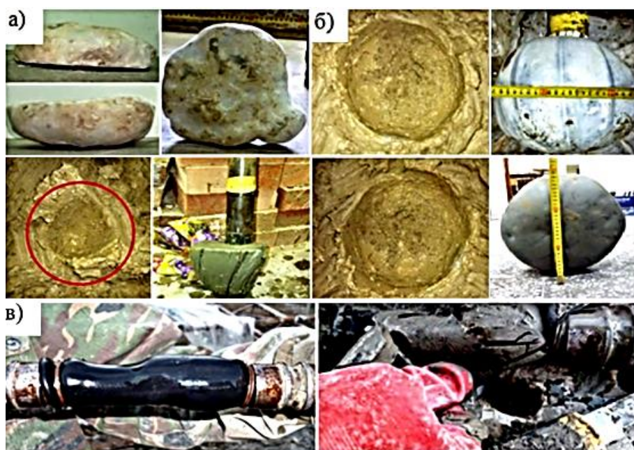
7-сурет – Стакан мембранасына ерітінділерді инъекциялау нәтижелері: а – № 4 құрам, б – №21 құрам, в – №4 құрам ерітіндісін инъекциялау кезінде қаптаманың бітелуі (автордың материалы).
