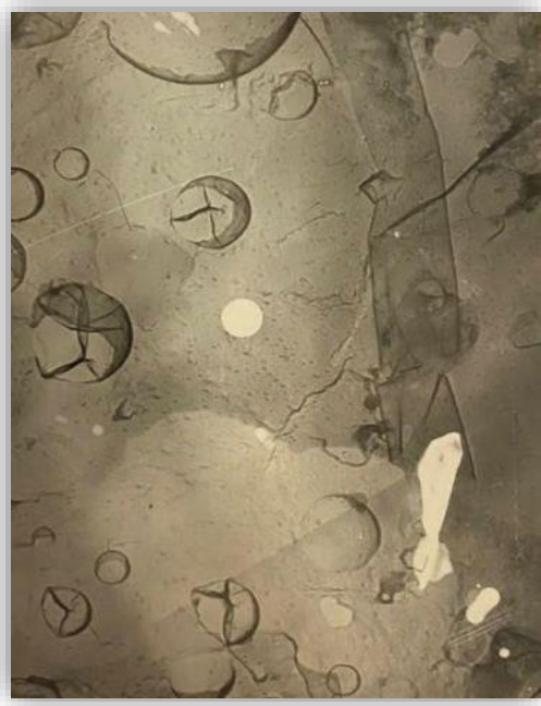
Рисунок 1 – Характер стеклофазы в золе Астана-Энергия ТЭЦ-2: а) сферические прозрачные частицы; б) микроучастки поризованного стекла с размерами пор 1-2 мкм; в) микроучастки стекла с размерами пор 3-5 мкм, г) микроучасток стеклофазы с макро- и микроликвационной структурой, обусловленной неоднородностью химического состава [материал авторов]
