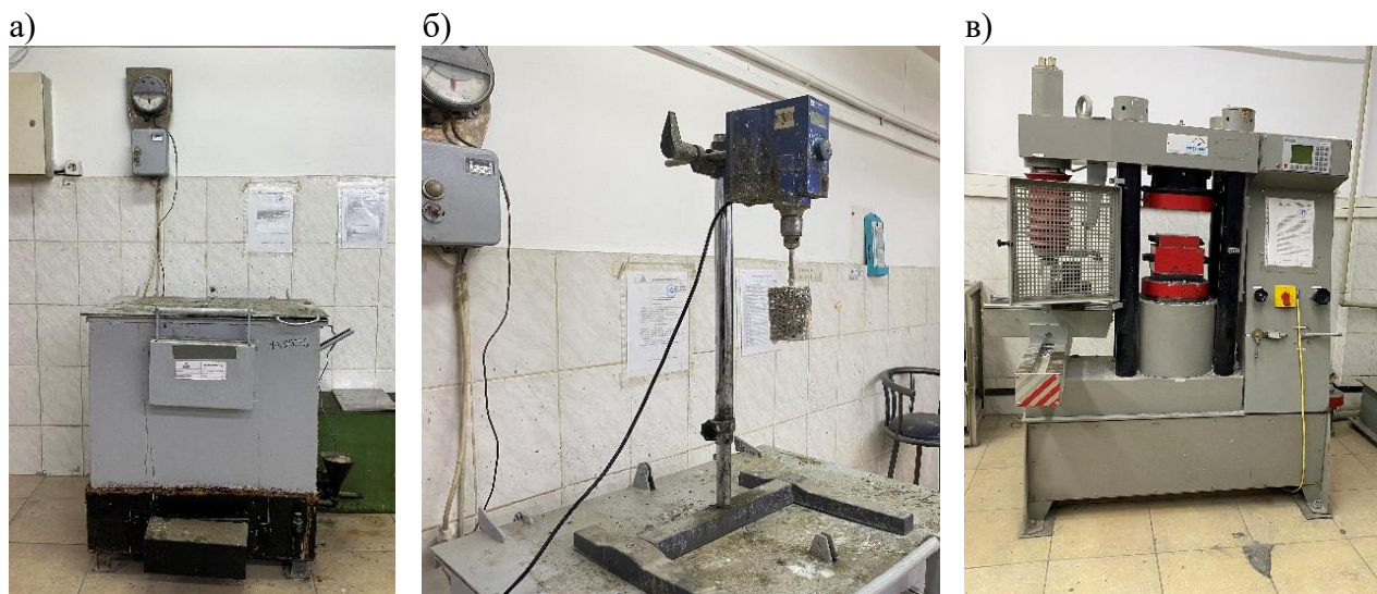
Рисунок 4 – Пропарочная камера (а), аппарат для получения пены (б), пресс германской фирмы «TESTING» (в) [материал авторов]
