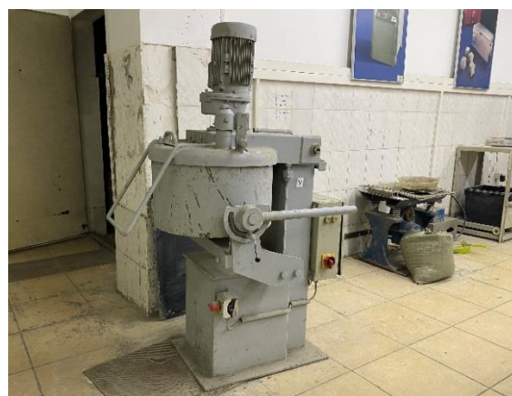
Рисунок 3 – Смесители германской фирмы «TESTING» емкостью 2 и 50 л, российской фирмы «НИКЦИМ Точмашприбор АЛС-5» емкостью 3 л
