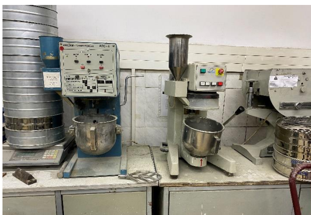
Рисунок 3 – Смесители германской фирмы «TESTING» емкостью 2 и 50 л, российской фирмы «НИКЦИМ Точмашприбор АЛС-5» емкостью 3 л
