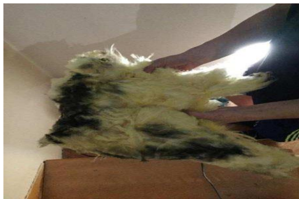
8-сурет – Мауэрлат арқалығы аймағындағы жылытқыштағы шаң шөгінділері
