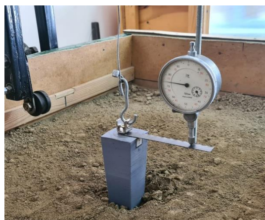
Рисунок 1 – Общий вид (а), схемы (б) и фрагменты испытаний (в) моделей свай
