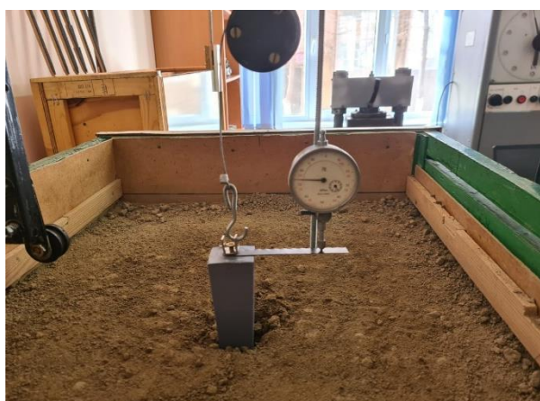
Рисунок 1 – Общий вид (а), схемы (б) и фрагменты испытаний (в) моделей свай
