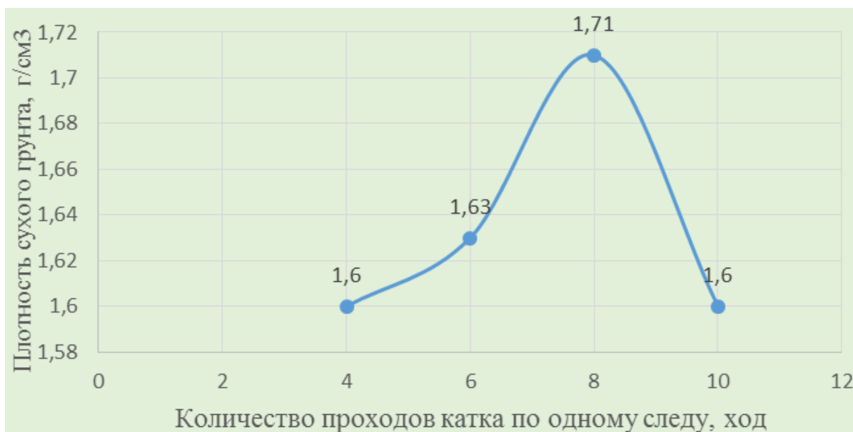
Рисунок 2 – График зависимости плотности сухого грунта от количества проходов катка по одному следу (кулачковый каток с вибратором 16 тонн, t=25 см).
