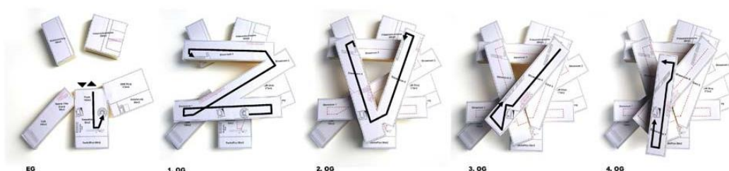
Рисунок 9 – Концепция формирования объемно-планировочной структуры Vitra Haus, с выносами консолей до 15 м. Архитектурное бюро Herzog & de Meuron [12]
