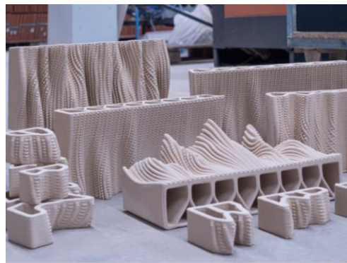
Рисунок 8 – 3D-печатные фрагменты фасада [8]
