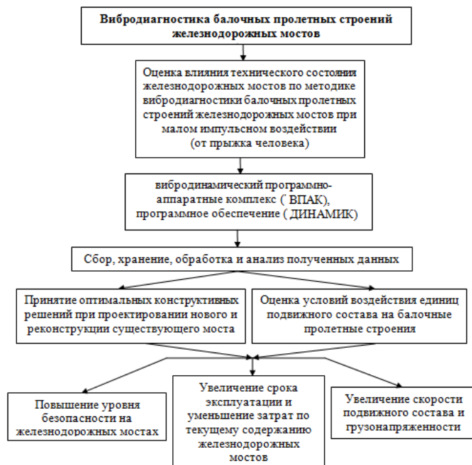
Рисунок 1 – Блок-схема мониторинга железнодорожных мостов [12]
