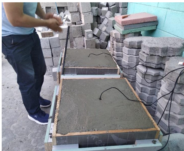
Рисунок 9 – Заливка образцов и установка датчиков
