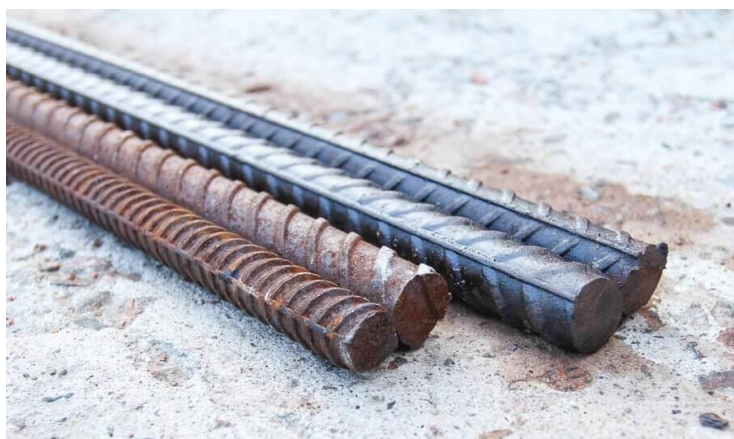
Рисунок 3 – Черный цвет коррозии на арматуре
