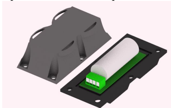
Рисунок 4 – 3D Модель построения квадратного корпуса вокруг платы
