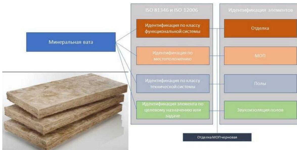
Рисунок 2 – Идентификация элемента по классам технических систем [4]
