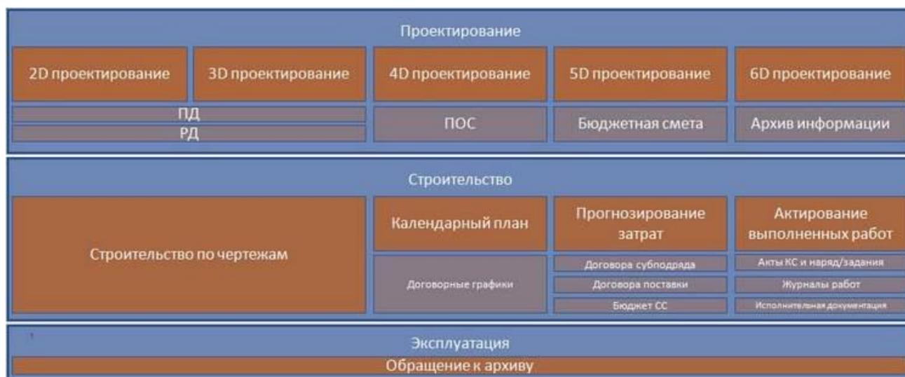
Рисунок 1 – Информационные модели стадий проектирования (подготовки проекта), строительства и эксплуатации [4, 5]
