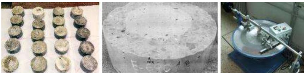
Рисунок 3 – Образцы бетонов, используемые при испытании на истирание (лабораторный круг истирания ЛКИ-3) [материал авторов]
