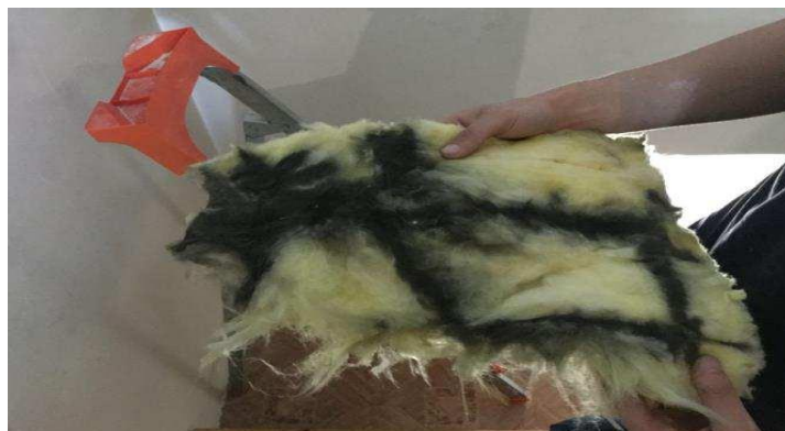
5-сурет – Жылытқышта тозаңды шөгінділердің болуы
