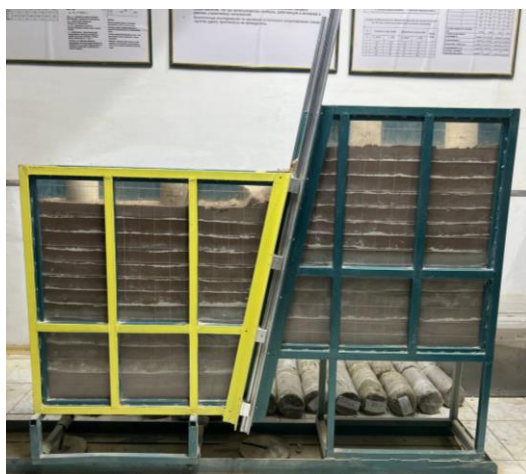
Рисунок 2 – Испытание №1. Результат сброса однослойный грунт – песчаный грунт [материал автора]
