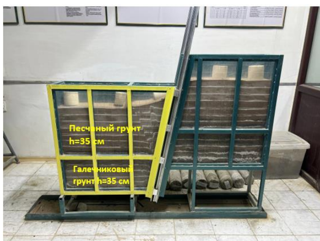
Рисунок 3 – Испытание №2. Двухслойная модель грунта испытанием сброса. Влияние тектонического разлома в реальном положении и схематичном [материал автора]
