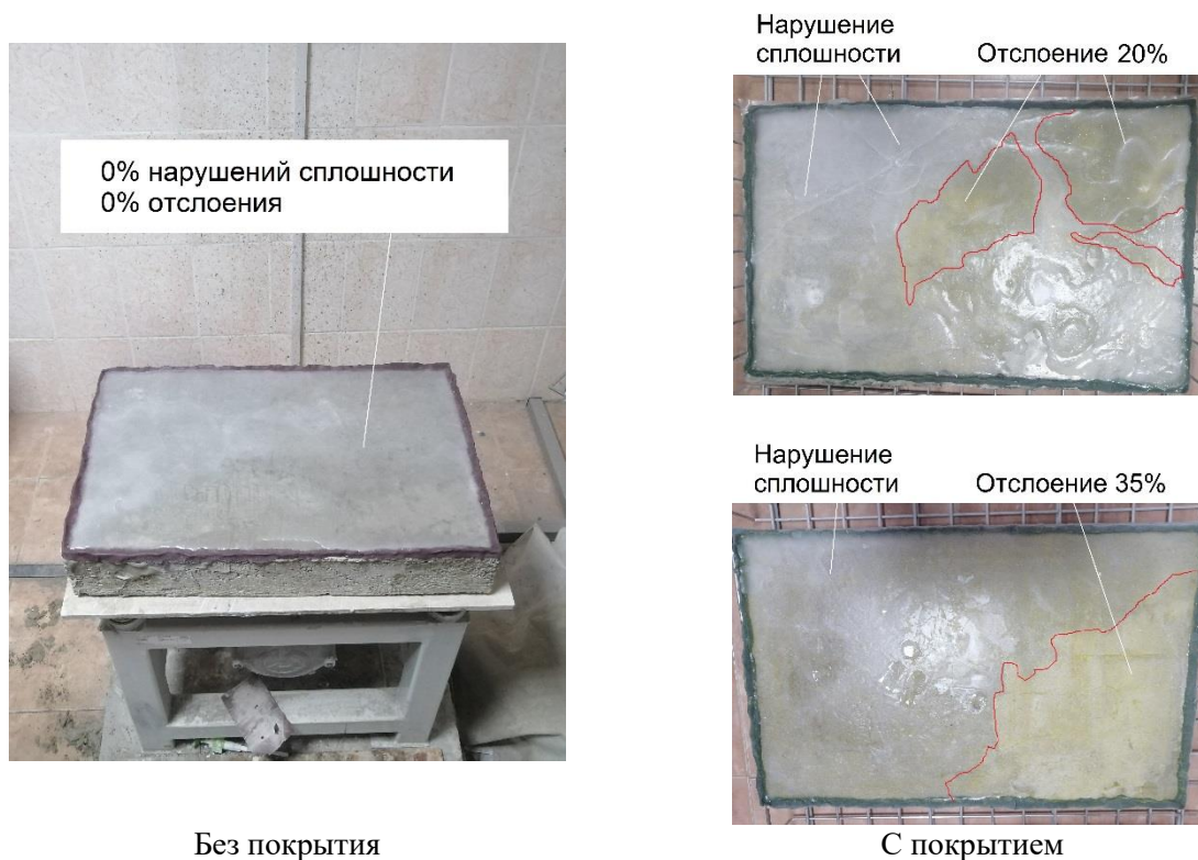
Рисунок 4 – Образцы, после моделирования термического напряжения [материал авторов]
