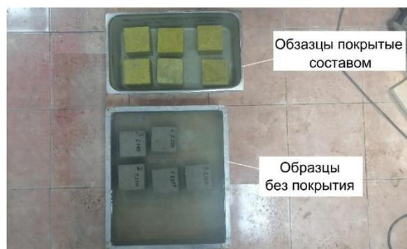
Рис. 3 – Кубические образцы на водопоглощение
