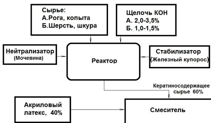
Рис. 1 – Технология производства пропиточного состава
