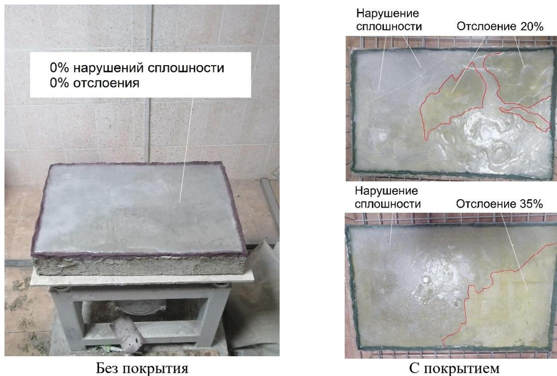
Рис. 4 – Образцы, после моделирования термического напряжения
