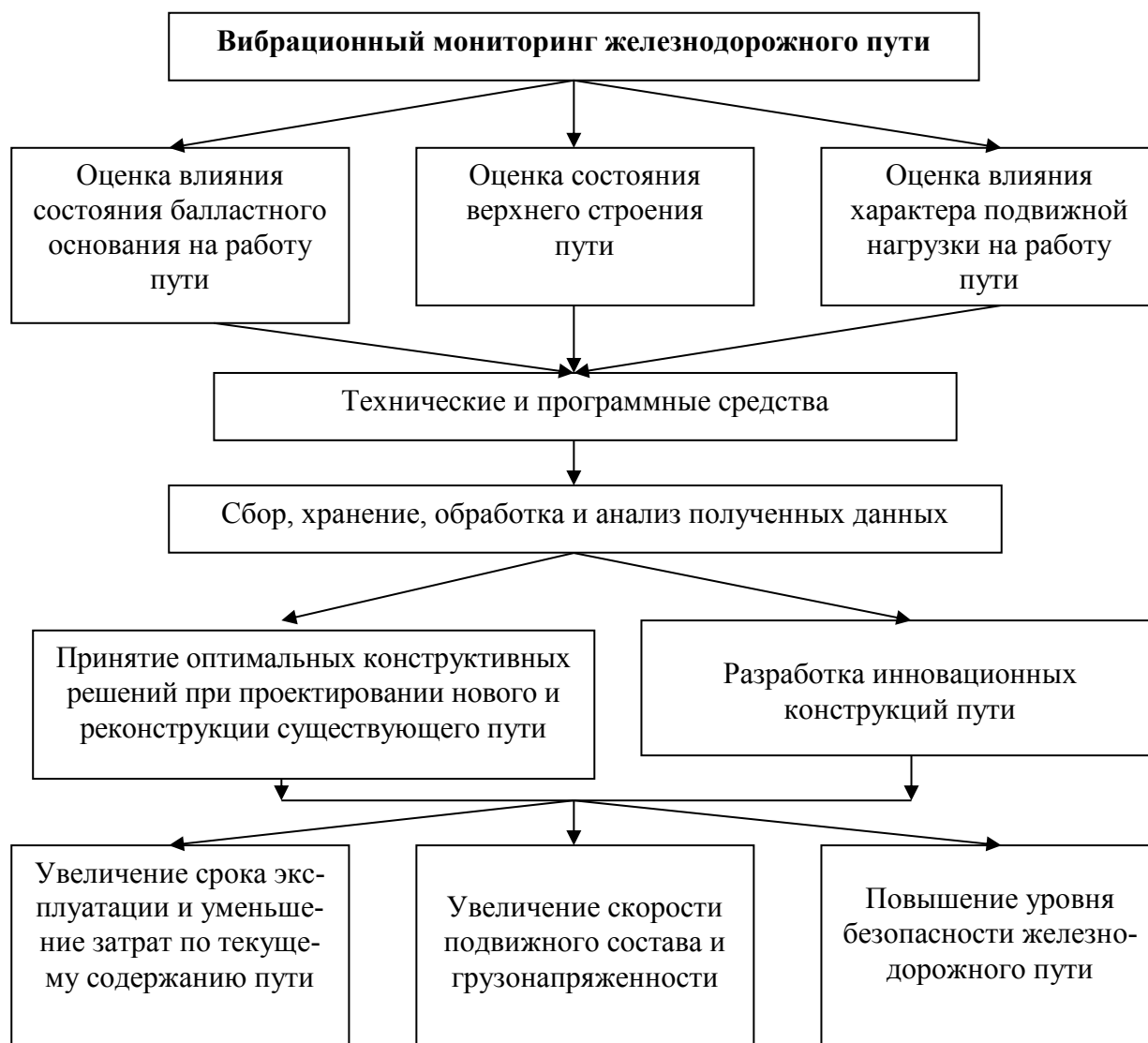
Рис. 2. Схема вибрационного мониторинга железнодорожного пути
