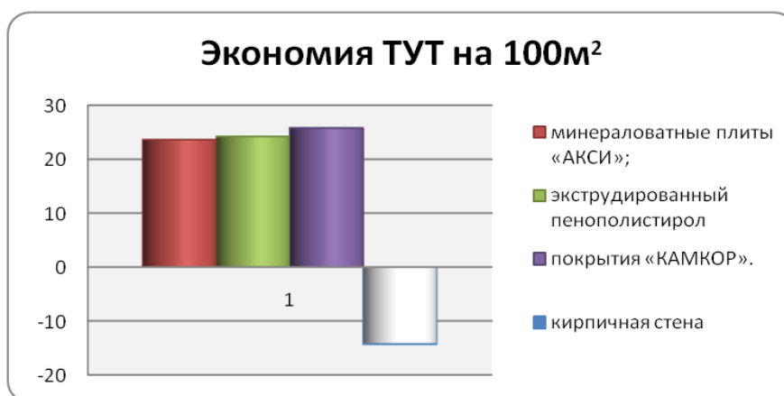
Рис. 4. Экономия тепла в пересчете в ТУТ при применении теплоизоляционных материалов для кирпичной стенки
