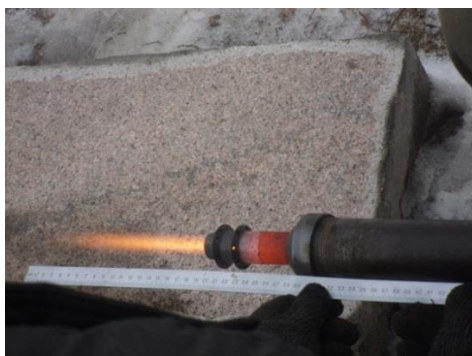
Рис. 1.2. Определение длины факела горелки терморезака
