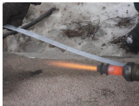
Рис. 1.2. Определение длины факела горелки терморезака
