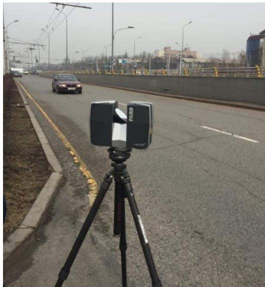
Рис. 3. Проведение съемки участка автомобильной дороги лазером Faro Focus
