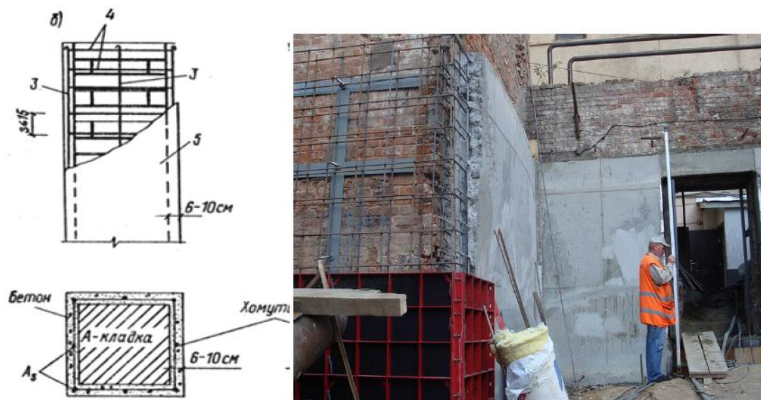
Рис. 2. Конструкции, усиленные железобетонной обоймой: 3 – вертикальный стержень, 4 – сварные хомуты, 5 – бетон
