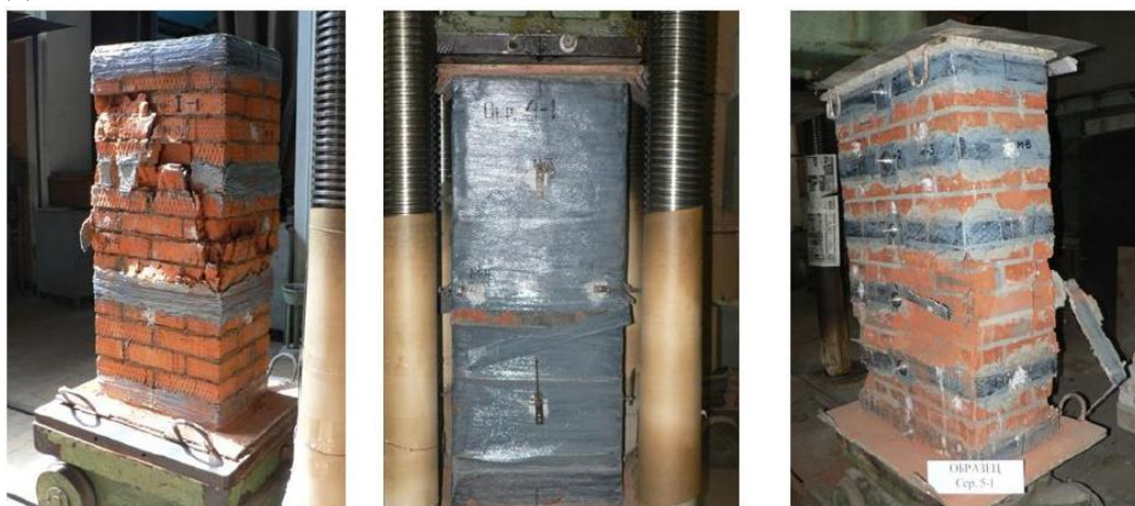
Рис. 6. Усиление кирпичной колонны композитом
