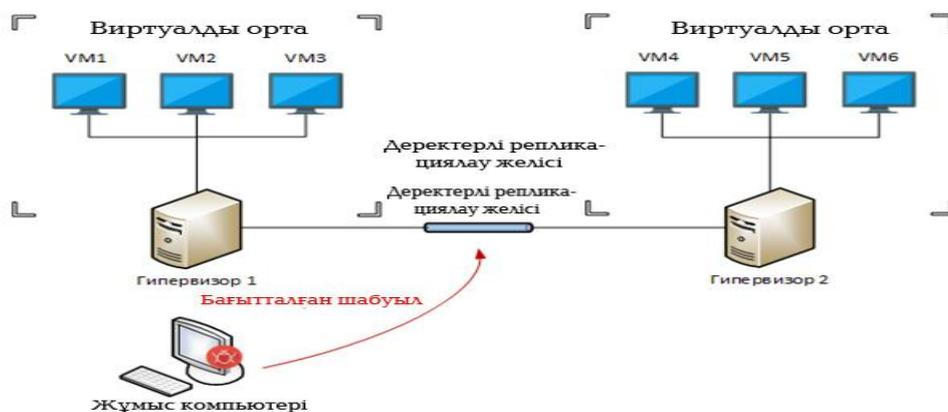
6-сурет. Деректерді репликациялау желісіне бағытталған шабуылдың үлгілік сызбасы
