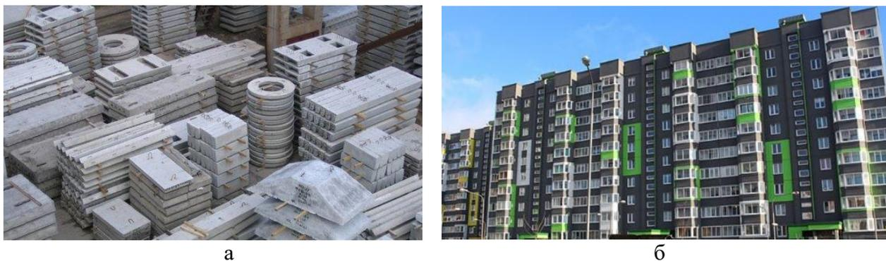
Рис. 1. а) Сборные железобетонные элементы; б) Современный панельный дом
