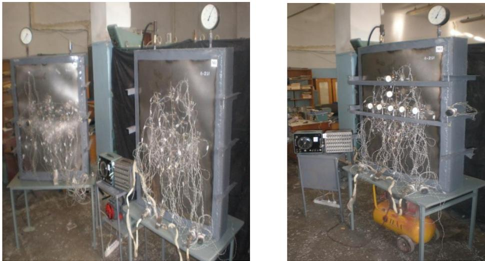
Рис. 1. Общий вид модели фрагмента стенки резервуара с вмятинами
