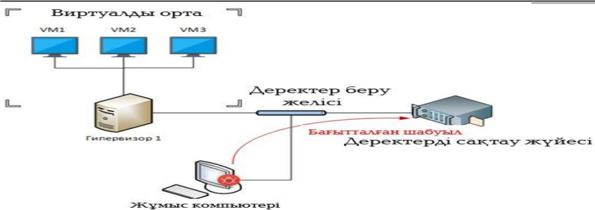
3-сурет. Виртуалдандыру серверінің деректерді сақтау жүйесіне бағытталған шабуылдың үлгілік сызбасы
