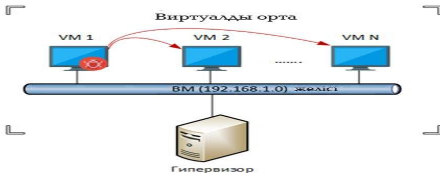
5-сурет. Виртуалды машиналарға бағытталған шабуылдың үлгілік сызбасы
