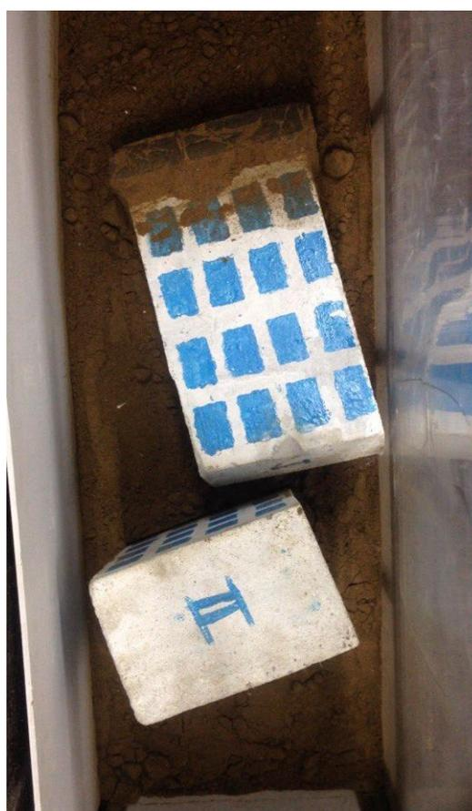
Рис. 6. Состояние моделей зданий после приложения вибродинамической нагрузки по второй стадии
