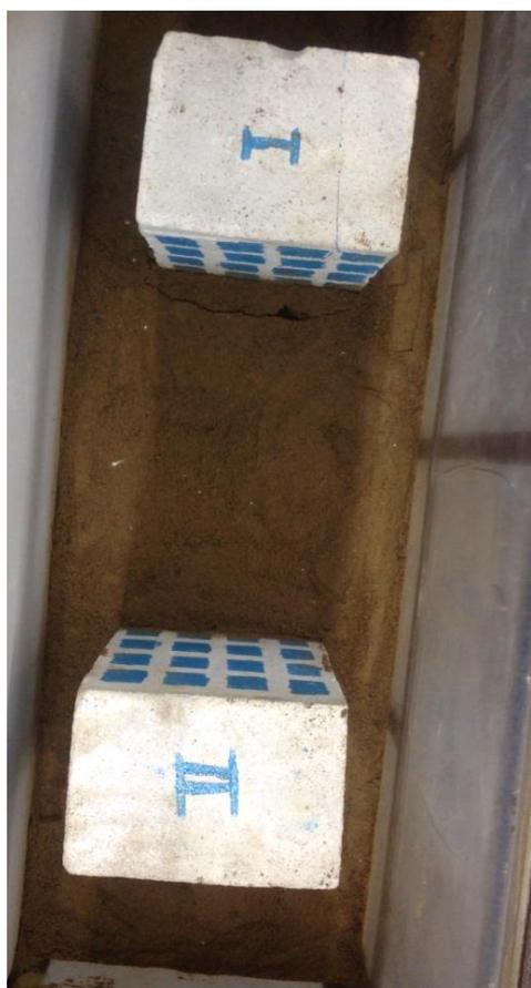
Рис. 5. Состояние моделей зданий после приложения вибродинамической нагрузки по первой стадии
