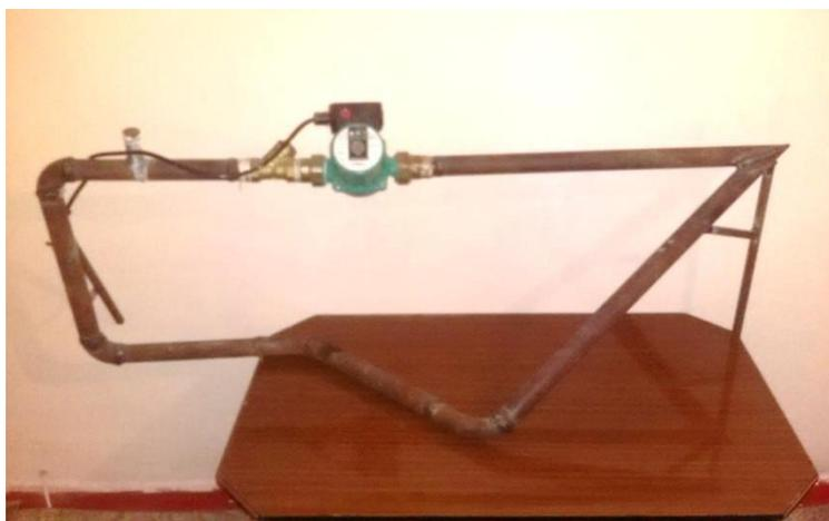
Рис. 1. Установка для определения коррозии на криволинейных участках в стальных трубах
