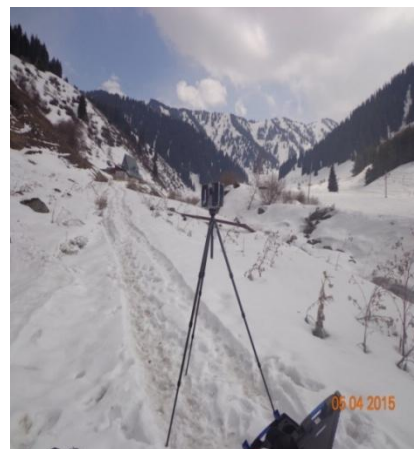
4-сурет. Сканерді жоспарланған нүктеге штативке орналастыру
