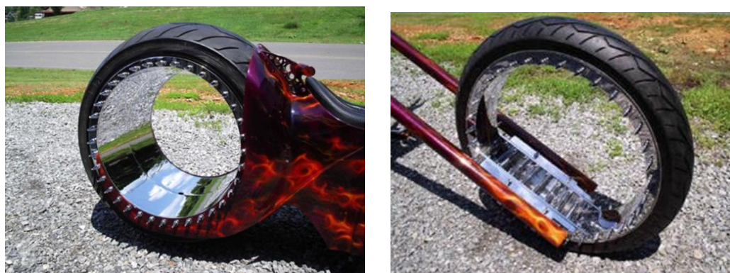
Рис. 2. Заднее и переднее колесо без ступицы, спиц и дисков
