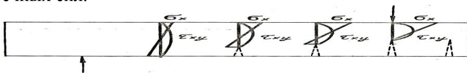
Рис. 1. Эпюры нормальных касательных напряжений в железобетонном элементе до образования наклонных трещин.
