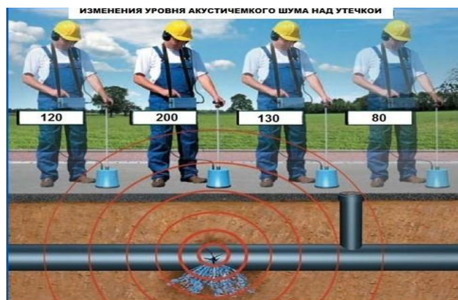
Рис. 2. Порядок определения места течи подземного водопровода
