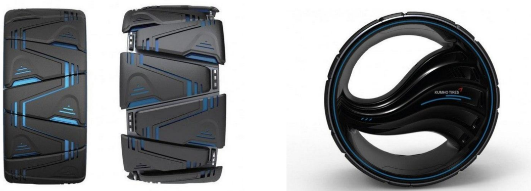
Рис. 4. Колесо Kuhmo's Maxpro, способное расширяться или сужаться.
