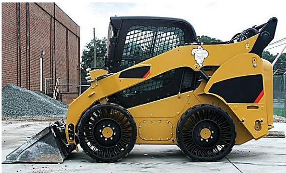
Рис. 11. Автопогрузчик с колесами «Tweel» от Michelin
